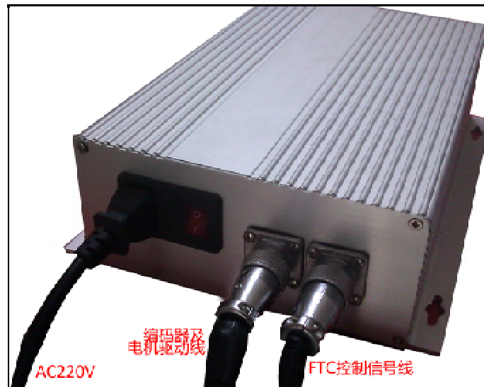
图 3-7 伺服电机驱动器及直流电源集成盒示意图
